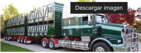
La compañía Byrne Trailers fundada en 1974, es líder en la fabricación de remolques para el transporte de ganadería y cargamento pesado en Australia. Recientemente, están utilizando acero inoxidable 3CR12 suministrado por Columbus Stainless en Sudáfrica y desde Roldan en España, para la fabricación de sus
