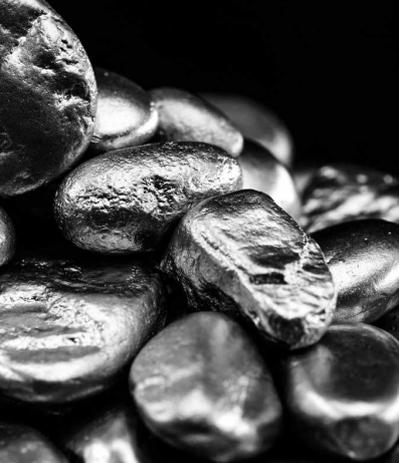
El níquel forma con el hierro una serie inalterada de soluciones sólidas. Más del 80 % del consumo mundial de níquel se destina a la producción de aceros inoxidables austeníticos y aleaciones de base níquel. Los materiales austeníticos tienen una red cristalina característica con una constante disposición atómica de los elementos.
