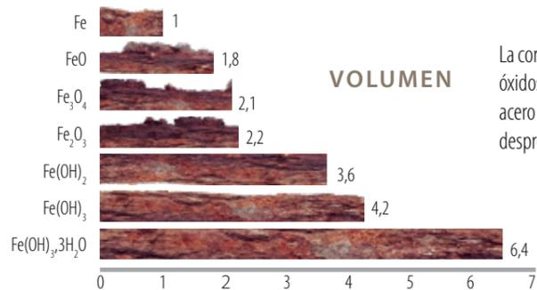
La corrosión del acero al carbono forma diferentes óxidos que ocupan un volumen superior al acero original lo que deriva en tensiones y desprendimientos.
