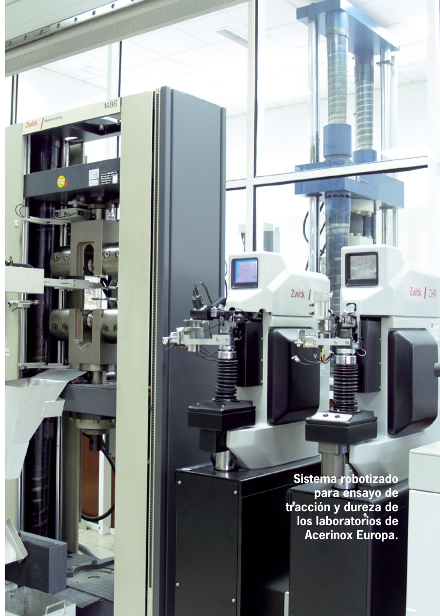
Sistema robotizado para ensayo de tracción y dureza de los laboratorios de Acerinox Europa.
