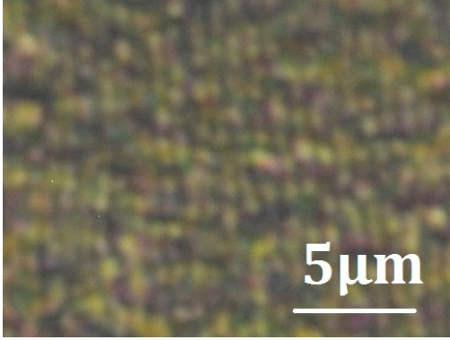
Fig. 4.1: Experimento 2. 150 pulsos y F = 0,2 J/cm^2 . LSFL con \delta \approx 650 nm .
