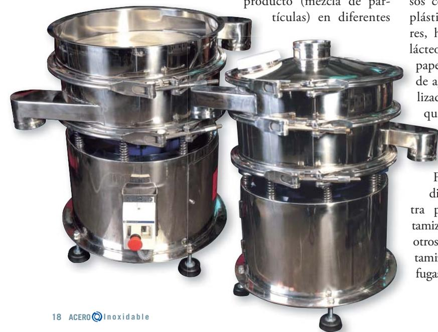
El bastidor de los tamices de laboratorio está fabricado en acero inoxidable AISI 304 y la malla metálica es de acero inoxidable AISI 316.
