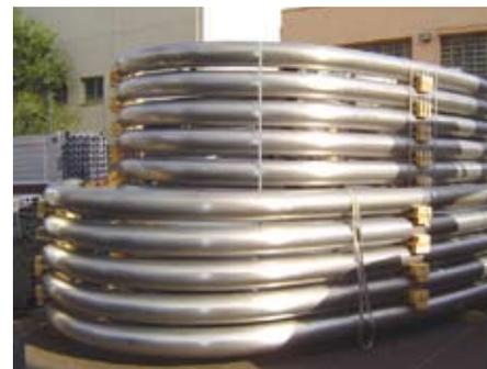
**L**a empresa Roig Curvado de Perfiles, S.A. ha participado en este proyecto con el curvado, a 3 radios distintos, de 120 tubos de acero inoxidable, más otros 120 tubos a 1 solo radio. Esta estructura cubre los dos andenes peatonales, situados en la parte inferior a ambos lados del puente.
