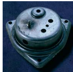
Pieza de acero inoxidable fabricada mediante estampación y soldadura.
