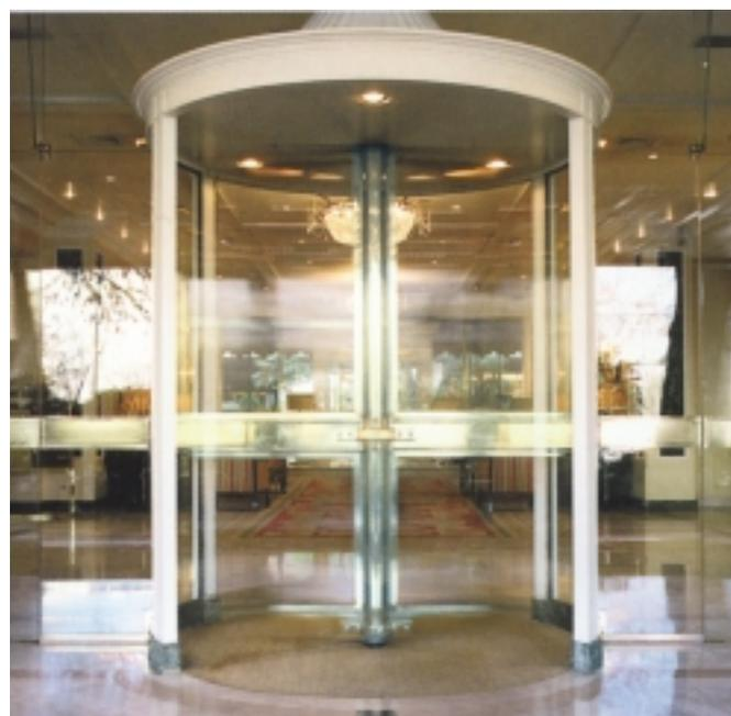
focos, techo en el mismo acabado de la puerta, automatismo TRP, pulsador de emergencia interior, pulsador para acceso de minusválidos, fotocélulas verticales, cerradura mecánica y perfiles plegados con sistema V-CUT.
