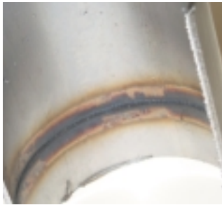
Foto 1 Soldadura sin purga
