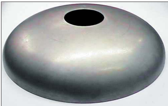
Foto 6.2.1.- Tapa para el depósito de aguas residuales del avión Airbus. Grosor inicial de la plancha 0,6mm, grosor de la pieza acabada 0,43-0,45mm. Diámetro 530mm.
