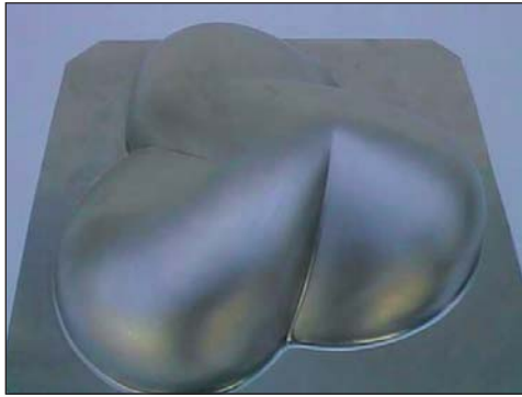
Foto 6.1.2.- Plancha deformada de un tubo 23 x 1.5 mm
