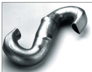
Foto 6.1.1.- Tubo conductor partiendo de un tubo 23 x 1,5 mm
