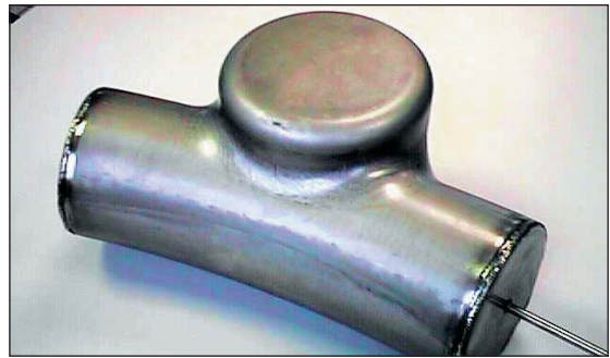
Foto 6.4.1.- Boquilla para el cohete Ariane, circuito cerrado para la circulación de líquido refrigerante (nitrógeno y oxígeno)
