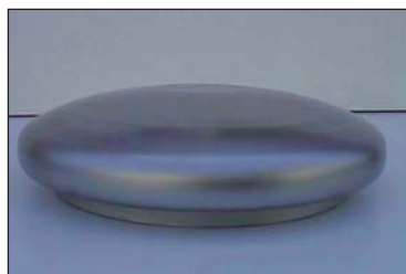
Figura 2: Incremento de la estabilidad mediante deformación hidrostática a partir de una superficie circular y deformación simultánea de elementos adicionales; grosor de la pared 0.2 mm; aleación 304.
