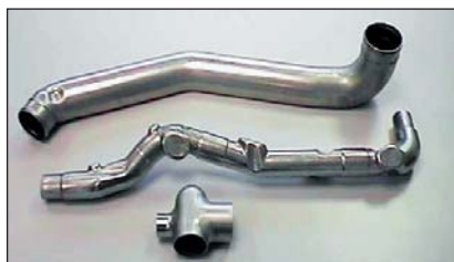
Figura 5: Radios variables, cambios de circunferencias y cortes transversales; aleación 309
