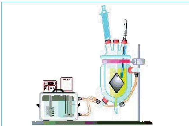
FIGURA 1.— Esquema de la célula de tratamiento
