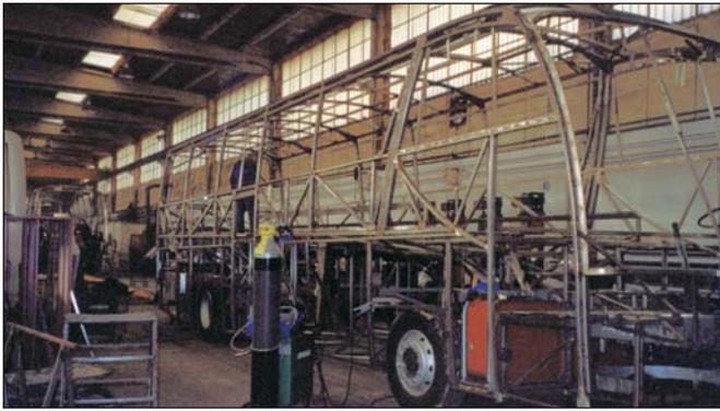
Esta estructura realizada en acero inoxidable ha permitido cambiar el criterio de diseño respecto al utilizado con el acero al carbono y su vez ha permitido reducir el peso del autobús.
