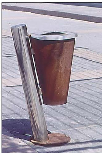
Sobre un mástil inclinado en tubo taponado de acero inoxidable, se traba esta papelera troncocónica realizada (en este caso) en acero cortén, con tapa circular en fundición de aluminio sobre la que se cala un triángulo equilátero, para la introducción de elementos desechables. La tapa inferior o cierre de la papelera, porta un círculo concéntrico de taladros, que permite la ventilación y desagüe
