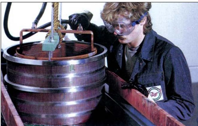
Electropulido de una cesta cilíndrica de acero al Cr-Ni para desbarbado fino y suavizado de su superficie.
