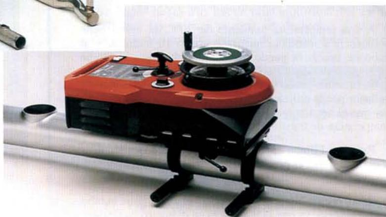
**T**-DRILL es un método que permite realizar, en un sólo proceso, derivaciones sobre el propio tubo, mediante la formación de un cuello. El procedimiento base es como sigue: una broca taladra el tubo, cuando ésta ha penetrado, de su interior salen unos dedos de extrusión, que al retroceder la broca hacia el exterior, levanta el cuello.
