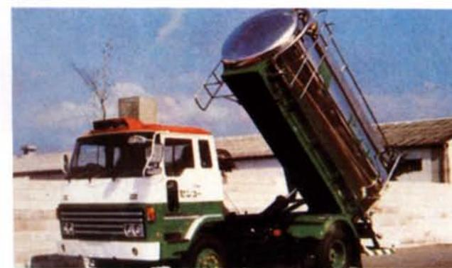
Los camiones con cisterna construida en acero inoxidable, se destinan al transporte de líquidos alimenticios (ya sea refrigerados o no), leche, vino, aceite, zumos de fruta, líquidos corrosivos, gases licuados a baja temperatura o productos en polvo.
