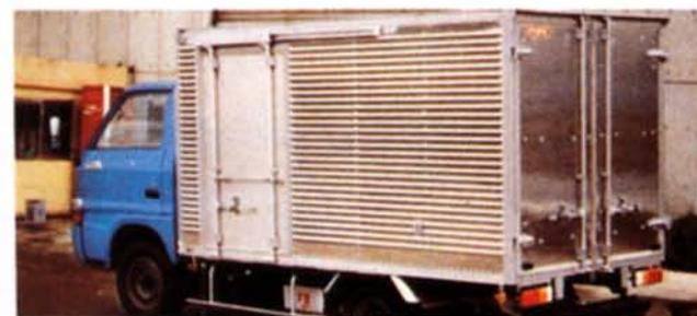
Ya en el año 1950 empezaron a desarrollarse en Estados Unidos este tipo de furgones donde al utilizar el acero inoxidable, empleando chapa grecada, pueden obtenerse estructuras ligeras pero de elevada resistencia mecánica sin ningún recubrimiento y evidentemente con un coste de mantenimiento bajo.
