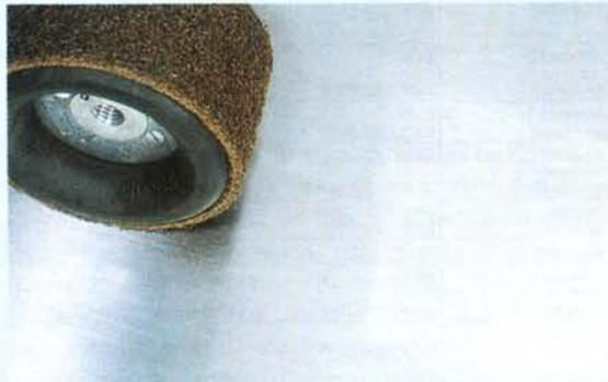
Banda de Scotch-Brite. Coarse o Medium. (3<sup>er</sup> paso)
