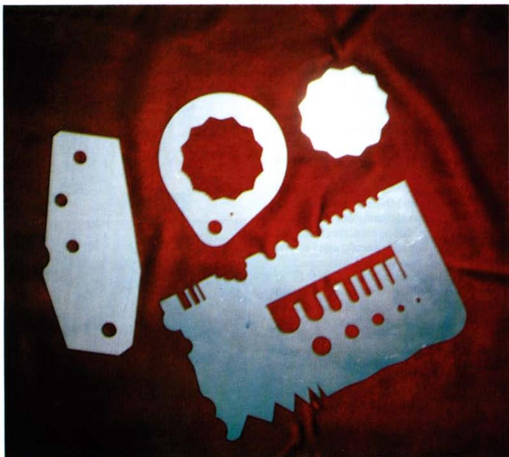
Cada día es mayor el número de industrias donde en los primeros procesos de fabricación es necesaria una calidad que evite trabajos posteriores de terminado (mecanizado y desbarbado) de piezas que incrementarían el coste. Además permite obtener complejos desmenbrados, evitando inversiones en herramientas, a diferencia de las punzonadoras, consiguiendo suprimir o simplificar procesos de fabricación posteriores, fundamentalmente soldadura.
