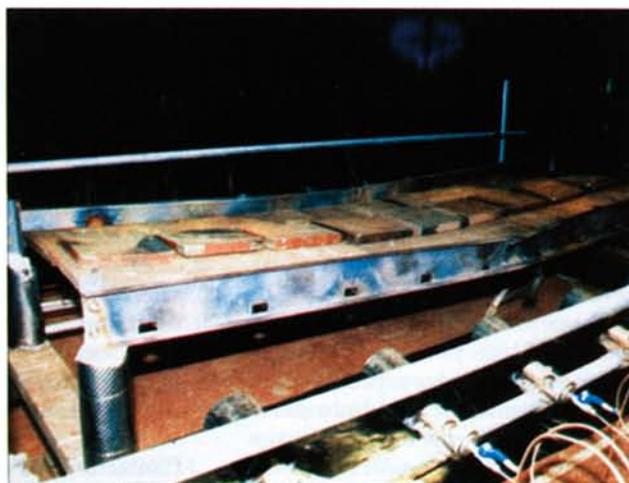
Escalera de acero inoxidable tras la prueba que se prolongó 45 minutos. La integridad estructural se mantuvo durante toda la prueba y la deformación en el centro de la misma fue de 80,5 mm.
