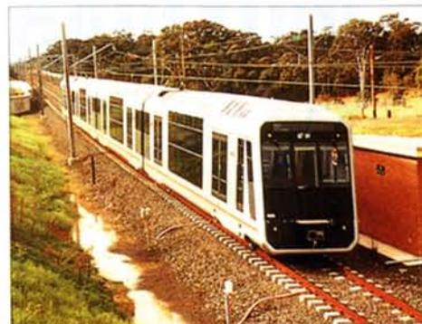
Vagones de dos pisos del tren australiano "Tangara". Nótese las paredes planas del diseño exterior.
