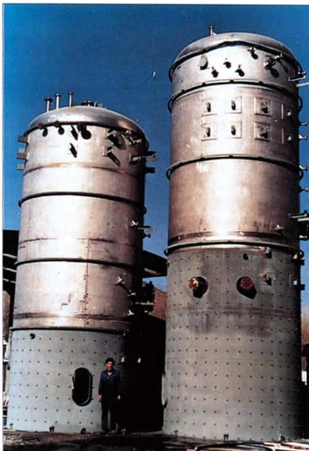
Equipos de procesos para una fábrica de ácido tereftálico. AISI 316L.
