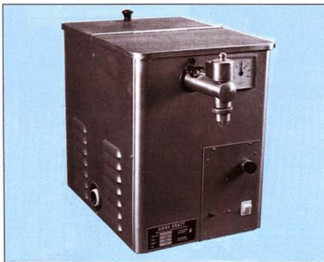
Estas montadoras de nata, automáticas e instantáneas, están construidas íntegramente en **acero inoxidable AISI 304**, con un contenido del 18% en cromo y 10% en níquel. Estas máquinas, de dimensiones reducidas y óptimas prestaciones, se han realizado en **acero inoxidable** por dos razones de peso: el fácil mantenimiento y limpieza y el alto nivel higiénico del material.
