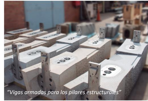
"Vigas armadas para los pilares estructurales"
