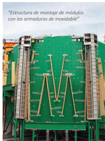
“Estructura de montaje de módulos con las armaduras de inoxidable”
