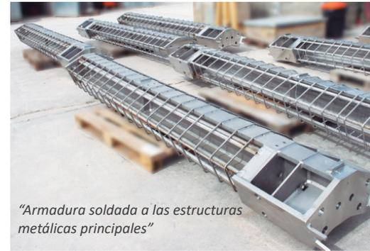
"Armadura soldada a las estructuras metálicas principales"
