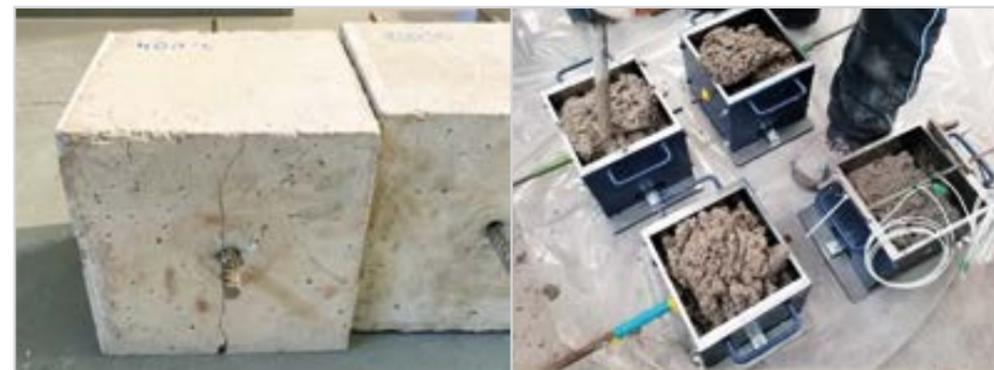
Fig. 2. Probetas de adherencia tras la acción de las altas temperaturas. Manufacturas Propias
