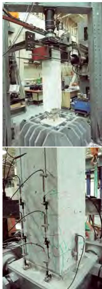
Figura 2. Configuraciones de ensayo de columna y control de carga
