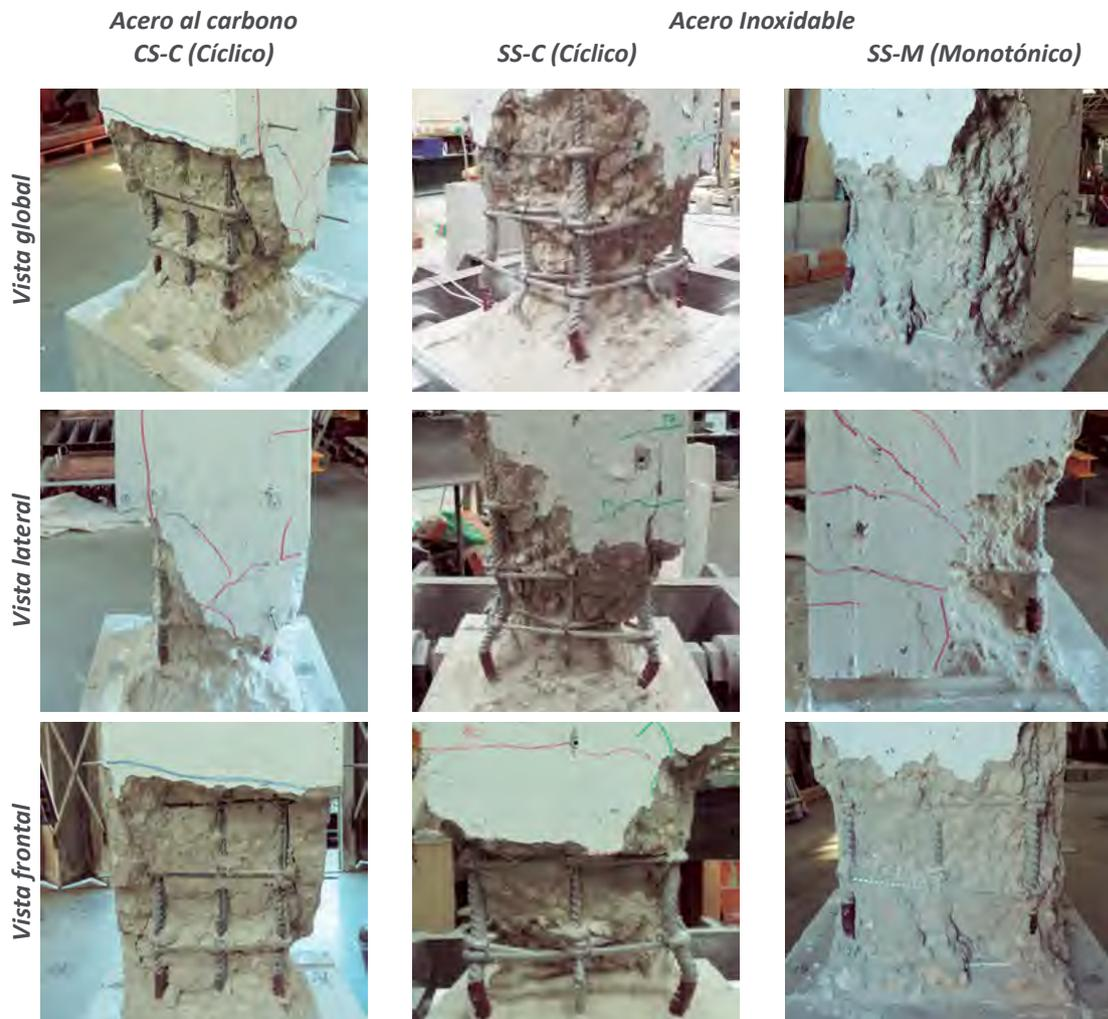
Tabla 3. Daños observados al final de los ensayos de las columnas
