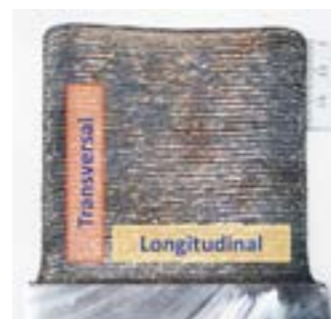
Paredes obtenidas mediante técnicas de DED en las instalaciones de Etxetar
