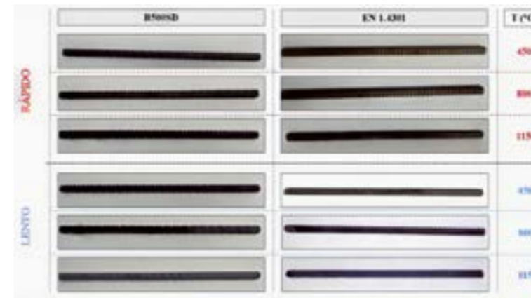
Figura 2. Apariencia superficial de armaduras B500SD y EN 1.4301
