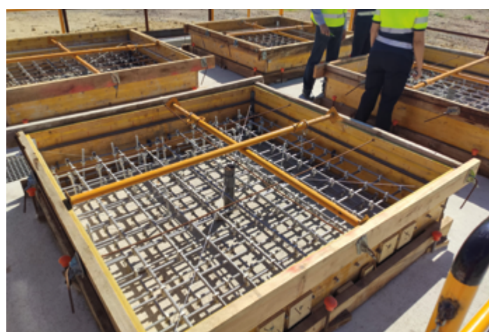
Figura 3: Losas armadas con acero al carbono y acero inoxidable ejecutadas con hormigón fabricado con EAI
