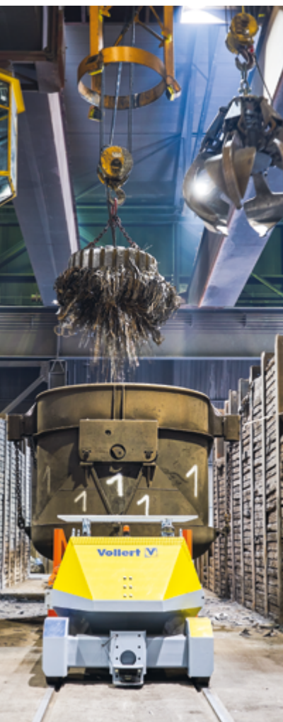
12 Figura 1: Carga de material reciclado durante la preparación de la colada
