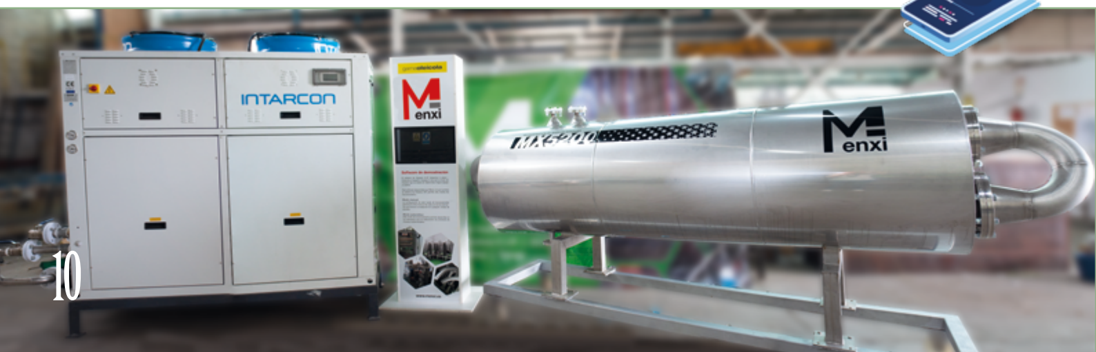
Máquina, configuración básica (intercambiador+enfriadora)
