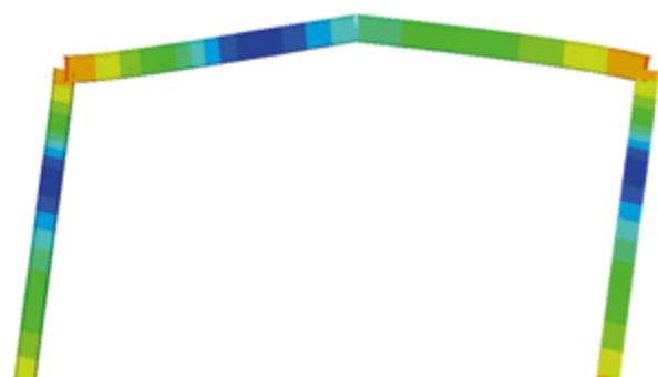
Figura 2. Deformada de un pórtico de acero inoxidable tras un análisis avanzado no lineal por elementos finitos.
