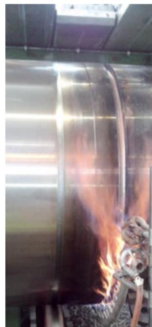
Figura 3. Soldadura del cuerpo del contenedor ENUN
