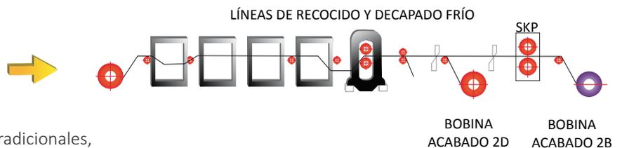
En el proceso de laminación en frío del acero inoxidable se pasa de la bobina negra al producto terminado con la reducción de espesor exacta en función de las características mecánicas a conseguir.
