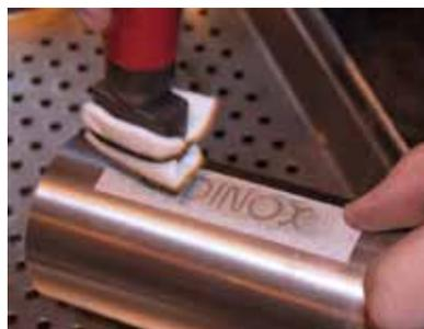
También sirve para realizar marcapjes con una plantilla o etiqueta impresa, se puede marcar en oscuro, con una capa de oxidación de la zona deseada. Ambos métodos son perdurables y resistentes contra los agentes químicos y la abrasión, y se usan a menudo para marcar herramientas o utensilios sanitarios.
