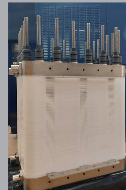
Stack de electrólisis de agua con membrana de intercambio aniónico (AEMWE) para la producción de hidrógeno verde
