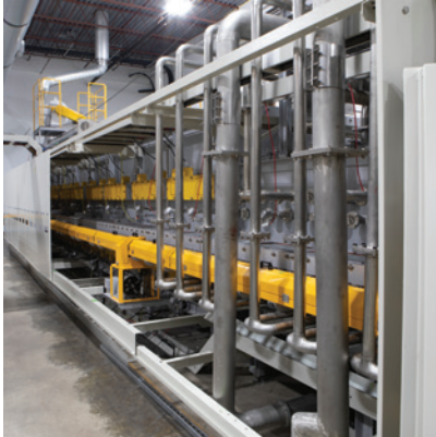
Horno de solera de rodillos (RHK) NOVONIX de 13,5 m de longitud, con las cubiertas aislantes retiradas, mostrando el sistema de manejo de gases y las cubiertas de los rodillos/calefactores.
