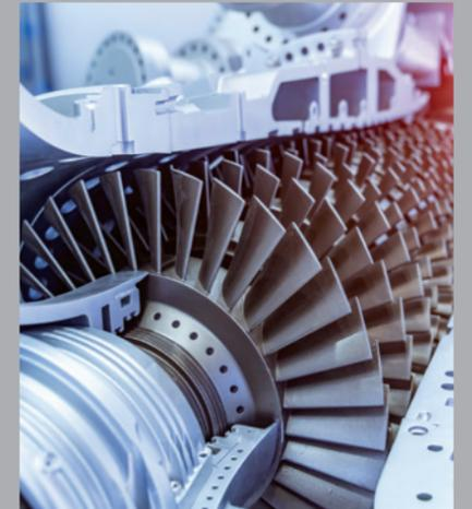
Las superaleaciones a base de níquel suelen estar compuestas por más de un 50 % de níquel y alrededor de un 20 % de cromo. Se utilizan cuando la presión y el calor son extremos.
