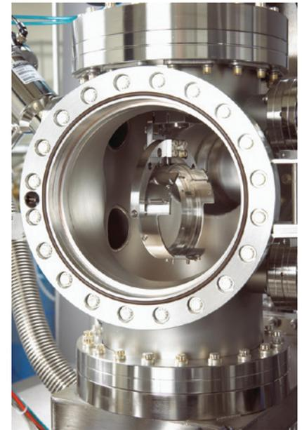
*Los equipos soldados, como esta cámara de vacío, que implican diferentes formas de producto, una amplia variedad de espesores de metal y un acabado superficial muy pulido, se producen más fácilmente utilizando aceros inoxidables austeníticos de la serie 300.*
