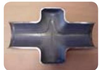
Deformación de la soldadura 1.4003.
