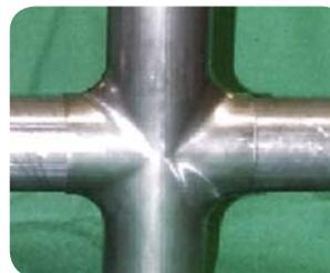
Hydrogeformtes geschweißtes Rohr (1.4003).
