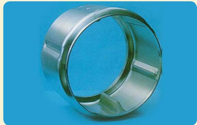
Trocknertrommel, geschweißtes Blech aus 1.4512 (409), expandiert.
