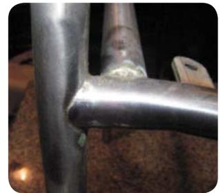
Hartlöten geschweißter Röhre aus 1.4509 (44Ti). © 2011
