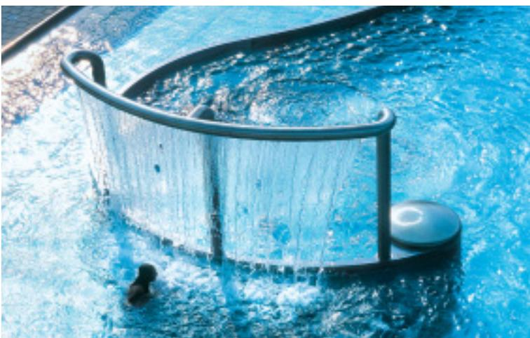
*Hohe Luft- und Wassertemperaturen können zusammen mit ständiger Wasserbewegung auch im Freibad den Chloridgehalt in Beckennähe erhöhen.*
