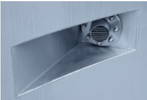
*Die Düsen des Strömungskanals sind in die Beckenwand integriert.*
