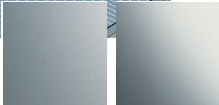
Werksseitige Oberflächen: 2B (links) und 2R (rechts).
