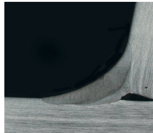
Der Ausschnitt zeigt eine dünne, konkave Nahtüberhöhung. Der Grund hierfür könnte eine zu hohe Schweißgeschwindigkeit sein.
