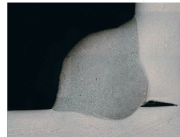
Der Ausschnitt zeigt eine konvexe Naht, was für dieses Verfahren typisch ist.
