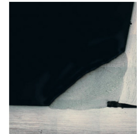
Der Ausschnitt zeigt eine leicht konvexe Nahtüberhöhung mit geringem Einbrand. Grund dafür kann eine zu hohe Anfangsgeschwindigkeit sein.
