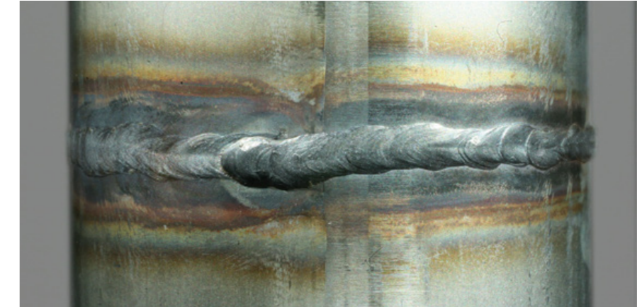
Zusatzwerkstoff: 1,6 mm, 19.9L Si Draht I: 40-50 A v: 4-6 cm/min Gas: reines Argon U: 10-13 V Bemerkungen: im gerade geschweißten Zustand: unregelmäßige Schuppung aufgrund des zu niedrig gewählten Stroms
