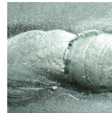
Nahaufnahme der Schweißnahtoberfläche; Schlacke ist sichtbar
