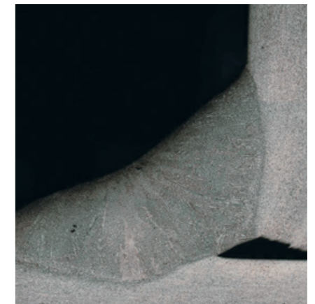
Der Ausschnitt zeigt einen eher geringen und asymmetrischen Einbrand.
