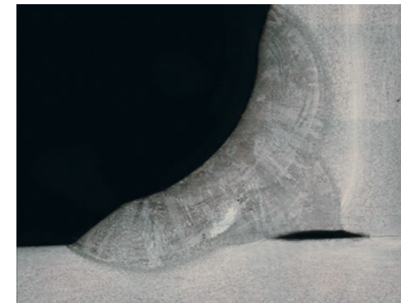
Der Ausschnitt zeigt eine konkave Schweißnaht.
