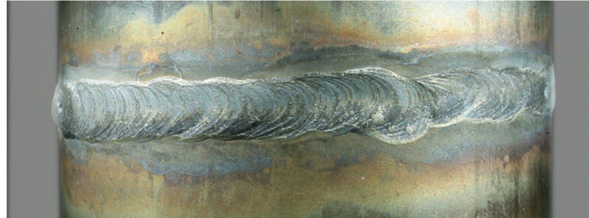
Zusatzwerkstoff: 1,6 mm, 19.9L Si Draht I: 45-55 A v: 4-6 cm/min Gas: reines Argon U: 10-13 V Bemerkungen: im gerade geschweißten Zustand: aufgrund nicht konstanter Schweißgeschwindigkeit eine eher unregelmäßige Schuppung
