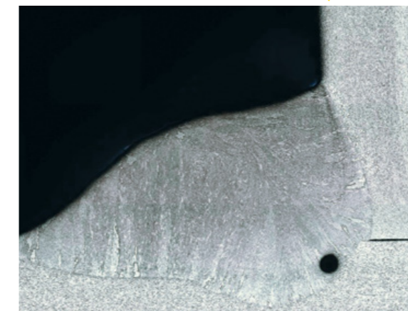
Der Ausschnitt zeigt eine eher asymmetrische und konvexe Nahtüberhöhung. Auf der Wurzelseite ist eine typische Porosität aufgetreten.
