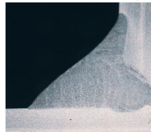
Der Ausschnitt zeigt eine leicht konkave Nahtüberhöhung mit einem niedrigen Spurwinkel. Der typische fingerförmige Einbrand ist sichtbar.
