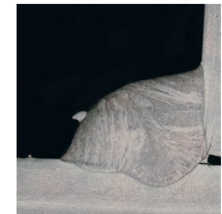
Der Ausschnitt zeigt eine konvexe Nahtüberhöhung. Eine höhere Spannung würde die Konvexität verringern. Auf der Oberfläche sind einige Spritzer. Dies ist für dieses Verfahren typisch.
