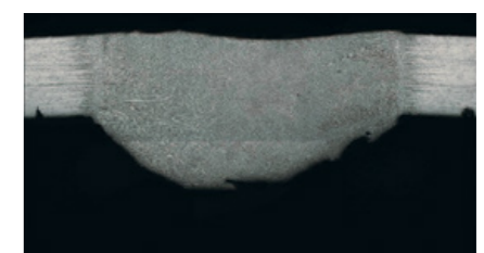
Der Ausschnitt zeigt eine Schweißung, die ohne Formiergas durchgeführt wurde. Der Wurzeldurchhang ist zu groß und im Wurzelbereich ist eine unregelmäßige, schwammige Oberfläche zu erkennen. Dies ist auf einen zu großen Wurzelspalt zurück zu führen.
