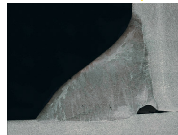
Der Ausschnitt zeigt eine eher konvexe flache Nahtüberhöhung.
