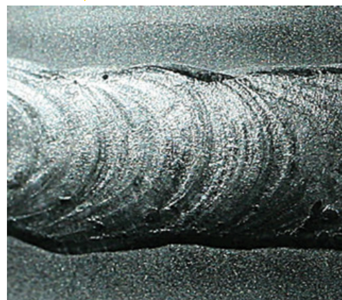
Nahaufnahme der Schweißnahtoberfläche; zu beachten ist die Schlacke im oberen Bereich.
