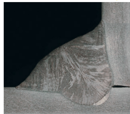
Der Ausschnitt zeigt eine eher konvexe Nahtüberhöhung.
