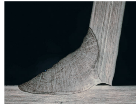
Der Ausschnitt zeigt eine konkave, flache Nahtüberhöhung.
