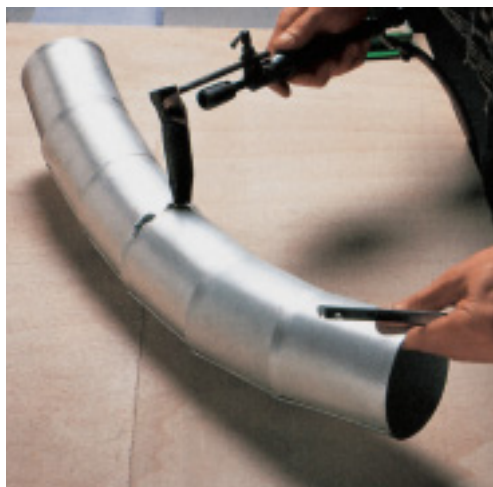
Soldadura demostrada en un codo articulado y en una sección de esquina de canalón.
