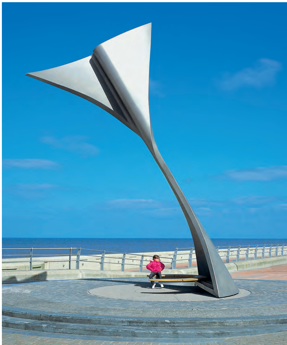
Tato plastika z duplexní korozivzdorné oceli (EN 1.4462) na Jižní pobřežní promenádě v anglickém Blackpoolu se otáčí jako větrná korouhev a poskytuje úkryt ve svém závětrří. Zadavatel: Městská rada v Blackpoolu; Architekt: Ian McChesney
