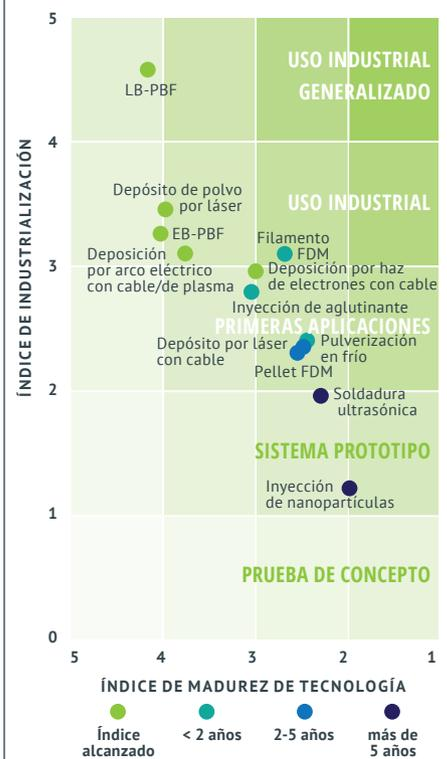
*Figura 2 Índice de tecnología y madurez industrial de las diferentes tecnologías de AM con metal*
