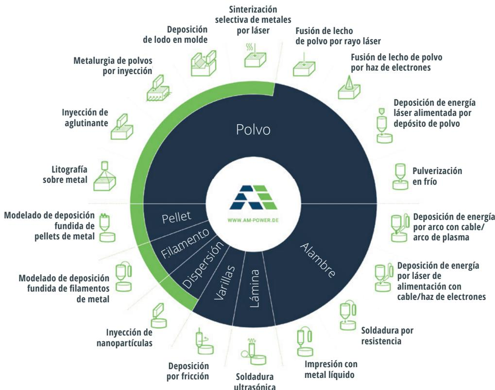
*Figura 3 Panorama de la tecnología Fabricación aditiva con metales. Se conocen más de 18 procesos diferentes de impresión en 3D con metales. AMPOWER Insights proporciona una visión general y una clasificación de los procedimientos más importantes.*
