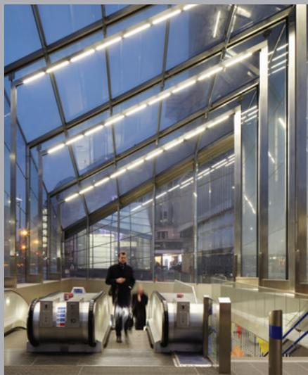
y la capacidad para fabricar bordes de radio mínimo fueron consideraciones importantísimas. Se usó el dúplex tipo 2205 (UNS S32205) para los elementos de construcción en la entrada más alta debido a su resistencia superior, que es el doble de la del tipo 316L (S31603). Se utilizó el tipo 316L para la entrada norte porque su resistencia era suficiente para la carga aplicada y la fabricación es más fácil. Los tapajuntas de metal de ambas entradas eran del tipo 316L. NI
