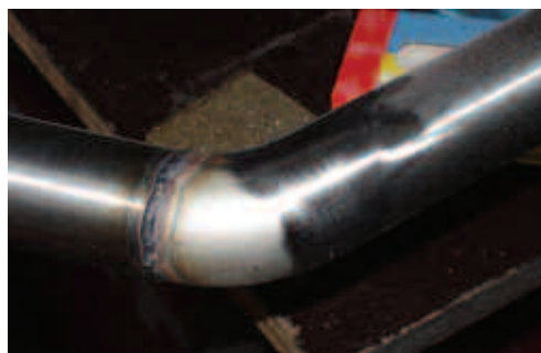
Zde se nevyskytuje ostrý vnitřní úhel
