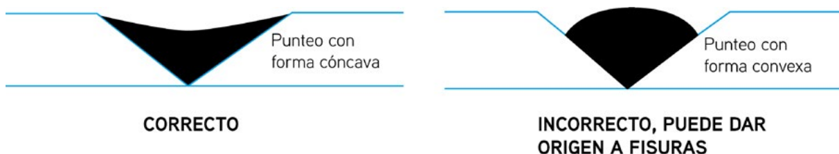
Fig. 6.1 Punteado correcto con forma cóncava, e incorrecto con forma convexa.
