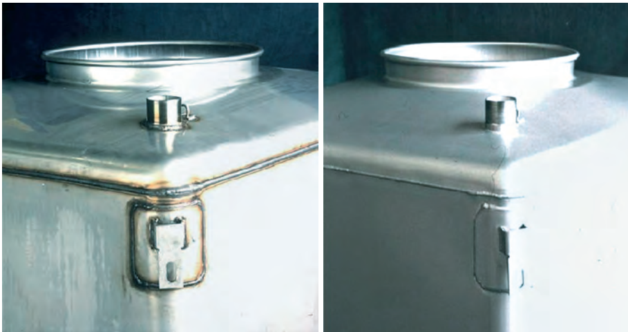
Il decapaggio rimuove efficacemente gli ossidi di saldatura durante la lavorazione degli acciai inossidabili.
