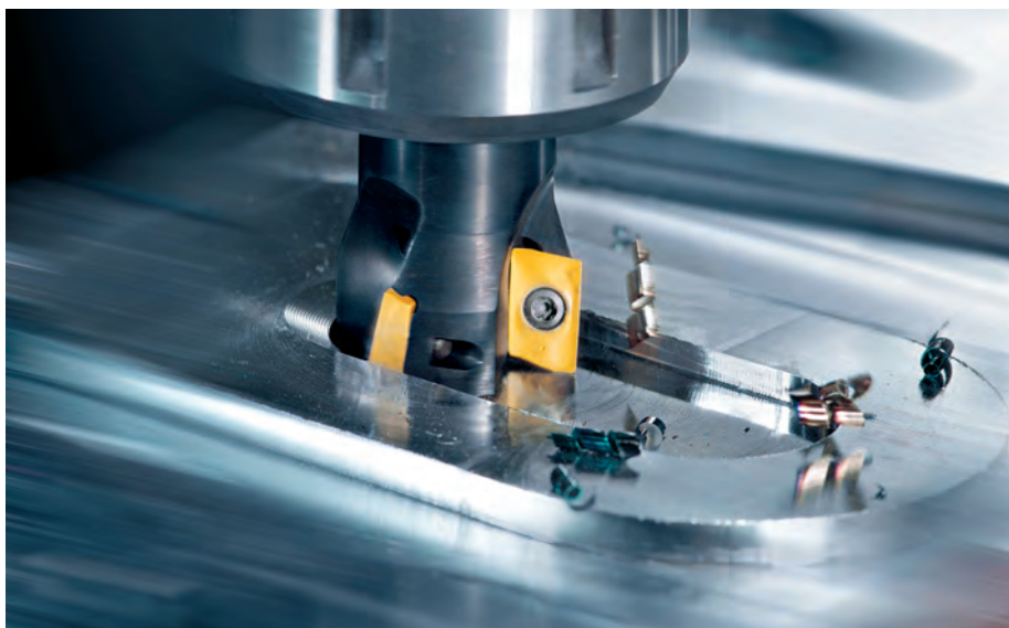
Fresatura a disco con utensili in carburo. © Seco Tools
