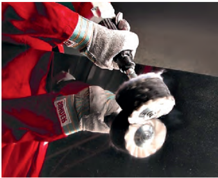
La lucidatura con dischi conferisce lucentezza alla superficie dell'acciaio inossidabile. © Magic Disc
