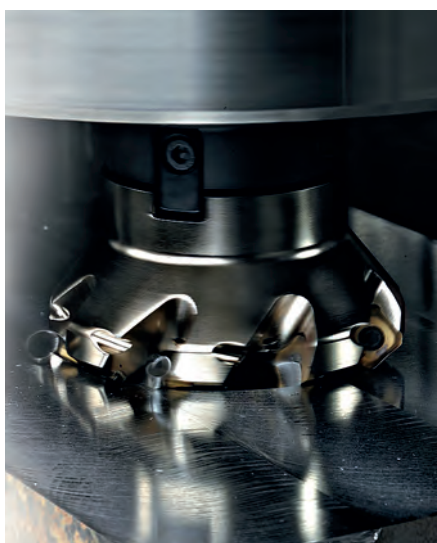
Fresatura frontale di acciai inossidabili austenitici con utensili ad inserto di carburo. © Seco Tools
