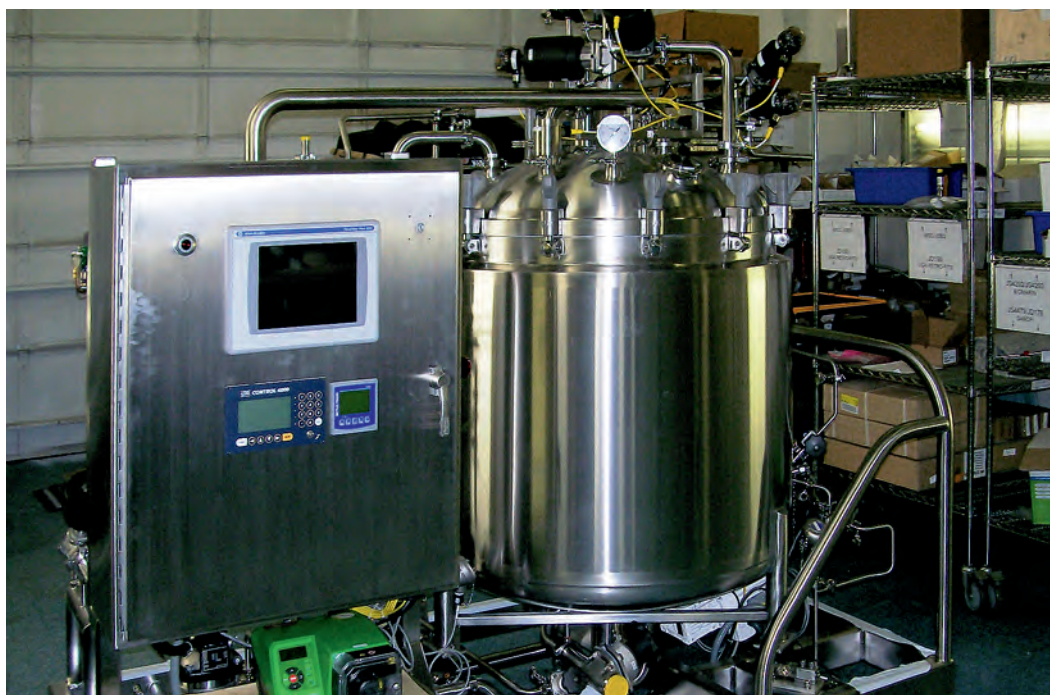
Recipiente portatile in acciaio inossidabile tipo 316L e pannello di controllo per l'industria bio-farmaceutica. © DCI, Inc, St. Cloud, MN USA
