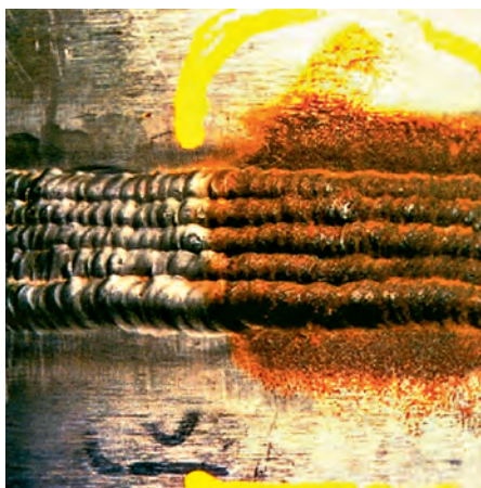
Spazzole di acciaio al carbonio usate per pulire acciai inossidabili possono causare scoloritura ed arrugginimento. © Outokumpu Stainless
