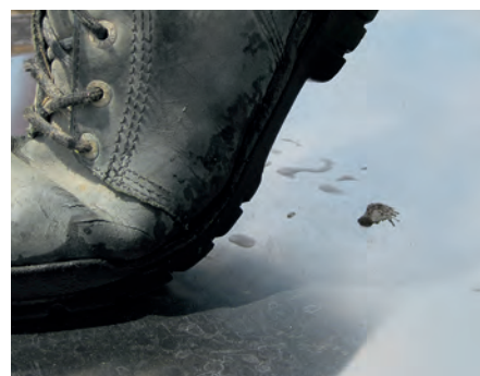
Non dovrebbe essere permesso camminare sugli acciai inossidabili. Coprire le superfici con carta, cartone o plastica, se gli operai sono costretti a farlo.
