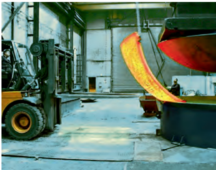
Formatura a caldo di spicchi per la testata di un recipiente a pressione, © Antonius Vesselheads BV
