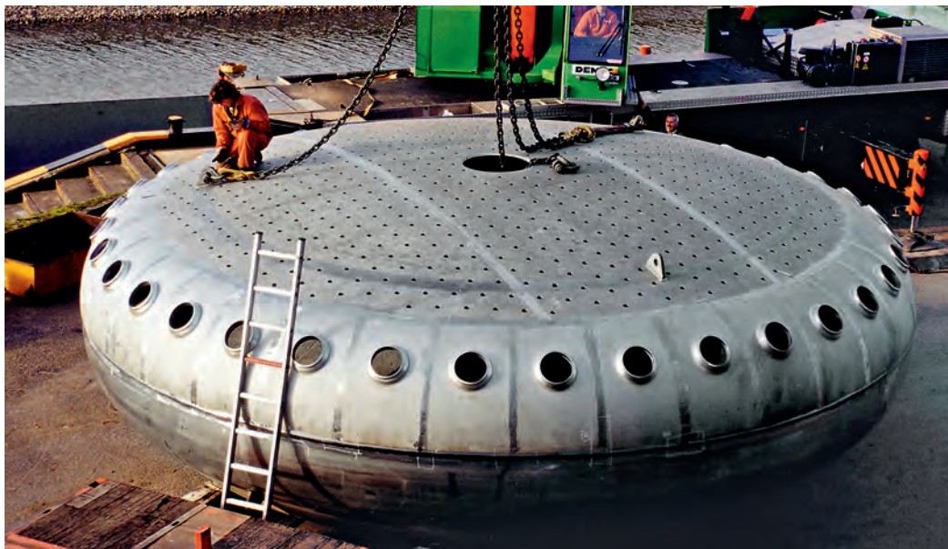
Il fondo di un grande reattore in acciaio inossidabile austenitico fabbricato con sezioni formate a freddo. © Antonius Vesselheads BV
