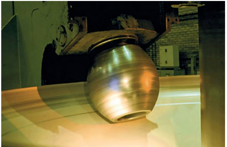
La tornitura in lastra del fondo di un recipiente di acciaio inossidabile austenitico sfrutta l'alta duttilità dell'acciaio e le modeste proprietà di incrudimento. © Antonius Vesselheads BV
