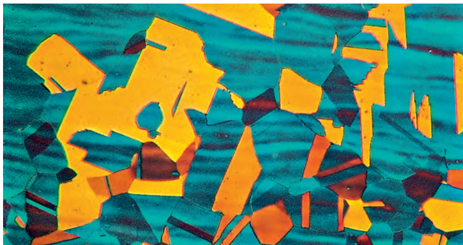
Figura 1: Microstruttura degli acciai inossidabili austenitici, che consiste in grani austenitici privi di precipitati ed altre fasi.
