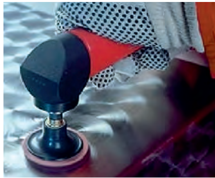
La lucidatura con dischi conferisce lucentezza alla superficie dell'acciaio inossidabile. © Magic Disc
