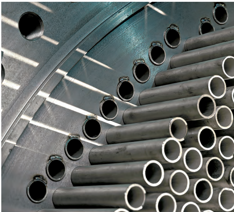
Scambiatore di calore a fascio tubiero durante la lavorazione. © Sandvik
