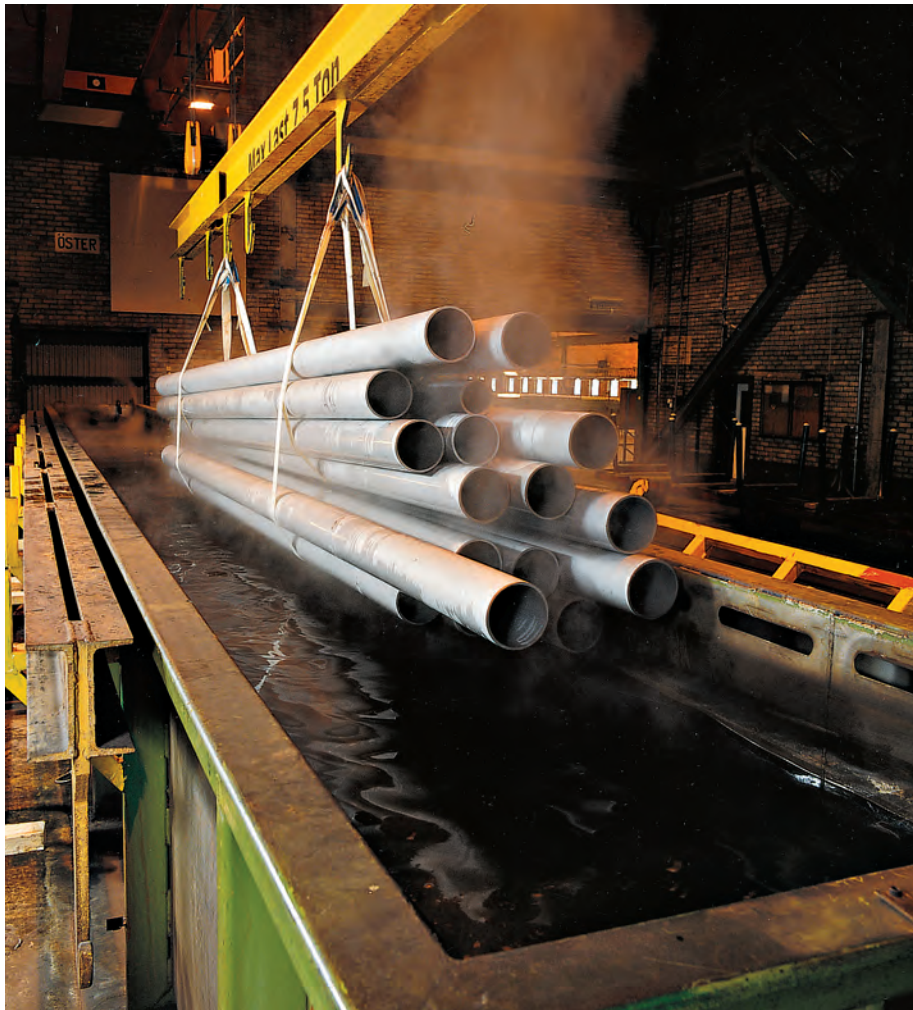
Sgrassaggio di un acciaio inossidabile austenitico. © Sandvik
