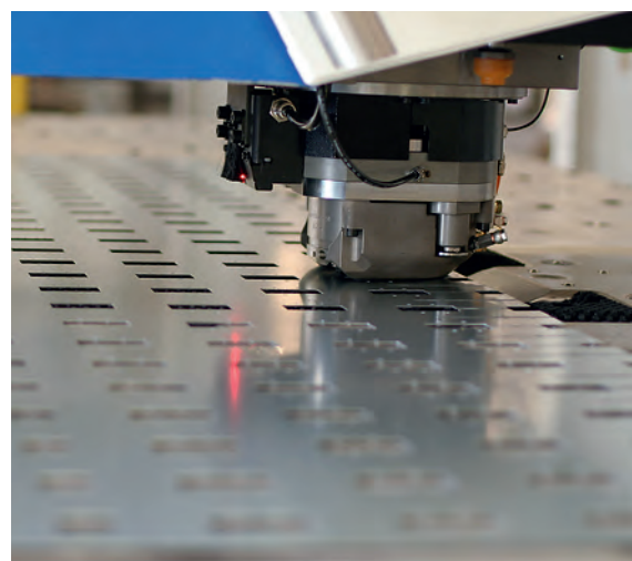
La punzonatura, uno dei tanti processi di cesoitura.
