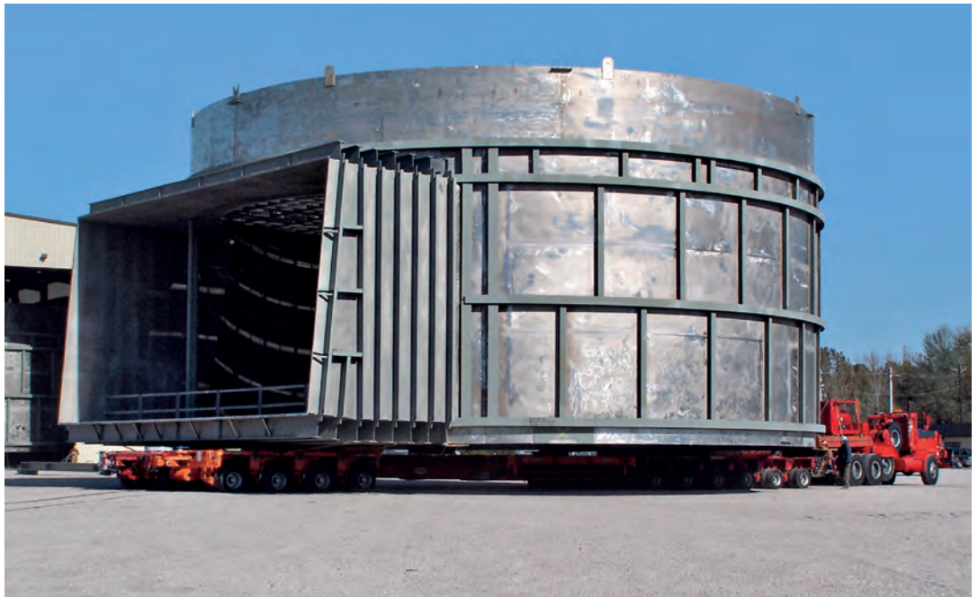
Rauchgasentschwefelungsanlage aus dem Stahl EN 1.4462 (2205); (Quelle: Aperam)
