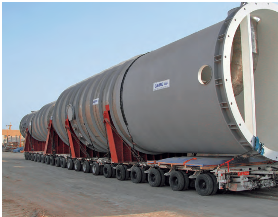
Fallfilmverdampfer aus nichtrostendem Stahl des Typs EN 1.4410 (2507); (Quelle: Gary Carinci, TMR Stainless)
