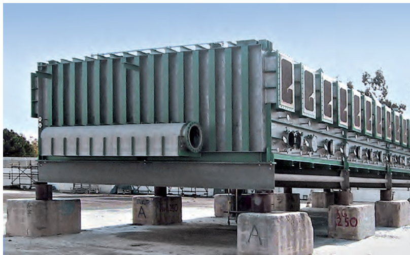
Mehrstufen-Verdampfer- Meerwasserentsalzungsanlage aus den Stählen EN 1.4462 (2205) und EN 1.4162 (UNS S32101); (Quelle: Outokumpu)
