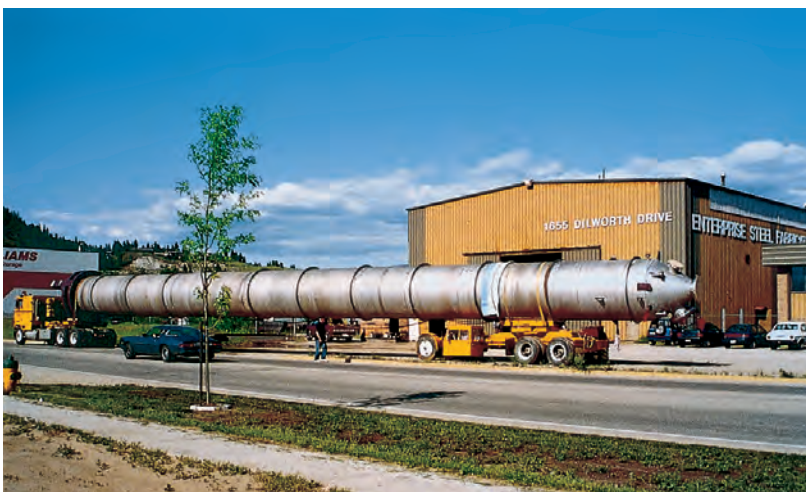
Sauerstoff-Entfernungsreaktor aus dem Werkstoff EN 1.4462 (2205), Enterprise Steel Fab, Kalowna, Prince George, British Columbia, Kanada (Quelle: Outokumpu)
