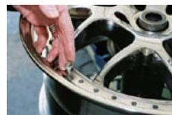
*Montaje del cubo de estrella en la llanta interior a través de la llanta exterior.*
