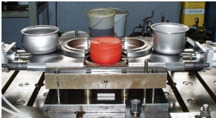
*El conformado del acero inoxidable no se limita a formas cilíndricas. También es posible dar al cilindro(derecho) un perfil curvo más complejo (a la izquierda de la imagen) con ayuda de una matriz de metales de dos piezas, de la forma final necesaria, y un punzón (centro) fabricado a partir de una serie de discos de polímeros duros de diversas propiedades.*
