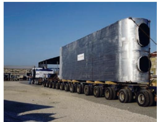
den tener hasta 2 m de anchura y 15 m de longitud. Tras el conformado por explosión lámina a lámina, éstas se apilan y sueldan juntas en grupo. Las ondulaciones en forma de V de las placas crean un patrón de flujo turbulento que asegura una elevada eficacia de la transferencia térmica.
