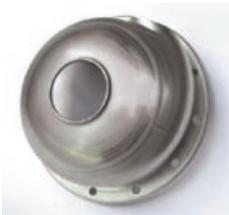
*Carcasa de bomba fabricada mediante embutición profunda a partir de una chapa de acero inoxidable. La entrada está situada en la parte frontal y el fluido abandona la carcasa a través de un orificio hidroconformado en la parte posterior.*
