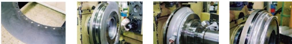
*Conformado por rotación de la llanta exterior. El acero inoxidable aumentará su resistencia durante el conformado para amortiguar impactos.*
