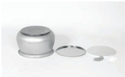
Si bien el aspecto mate del disco de partida carece del brillo requerido por el diseñador, la rugosidad de su superficie es lo suficientemente baja como para que el acabado final sea admisible.
