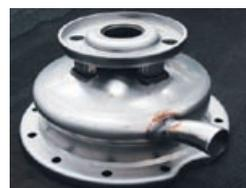
*Etapas de la fabricación de una carcasa: embutición profunda, hidroconformación, taladrado y fresado, aplicación de accesorios*
