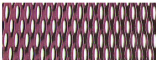
*Durch Überschleifen wird bei mustergewalztem, gefärbtem Edelstahl Rostfrei die Farbe im Bereich der Kuppen abgetragen. Hierdurch entsteht eine attraktive Kontrastwirkung.*
