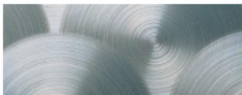
*Spezielle Schleiftechniken ergeben zum Beispiel eine richtungslose Mattierung, Hairline-Finish, Kreuzschliff oder Pfauenaugen-Schliff.*
