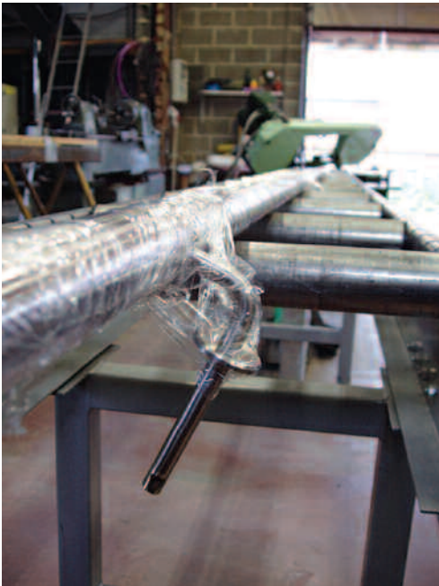
Gepaste bescherming van constructies is noodzakelijk, indien men beschadiging en vervuiling – door b.v. vreemd ijzer – wil vermijden gedurende opslag, verplaatsing en transport.
