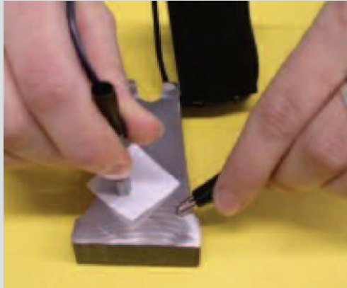
Gemakkelijk hanteerbare elektrochemische testmethoden zijn voorhanden om te bepalen of een roestvast staal molybdeen bevat (links) of niet (rechts).
