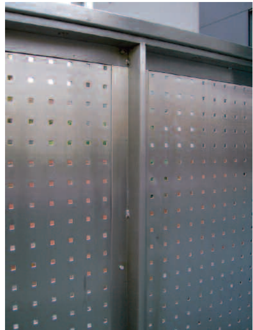
Plaatselijke roestvorming werd veroorzaakt door ijzerdeeltjes achtergebleven op een schuurmiddel (schijf) dat voordien voor koolstofstaal gebruikt werd (links). Indien roestvorming door ijzerdeeltjes optreedt, kan het verholpen worden door ter plaatse na te beitsen (rechts) [12]
