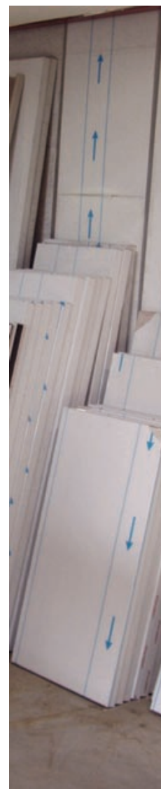
Un film plastique pelable indique typiquement la direction du laminage.
